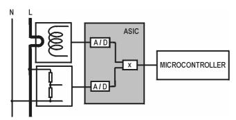
Fig. 21: Metering element
