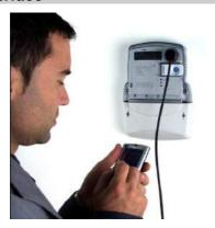
Fig. 28: Meter readout via an IR optical interface
