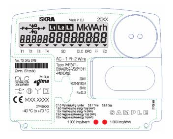
Fig. 40: ME371-D3 meter front plate
